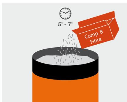
5) Inserire gradualmente il Componente B (fibre), continuando la miscelazione per almeno 2-3 minuti fino ad ottenere una dispersione omogenea delle fibre.
