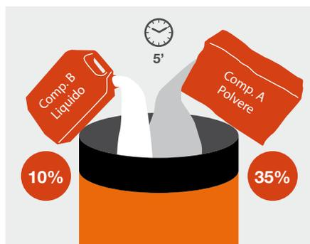
4) Introdurre i rimanenti Componente A (polvere) e Componente B (liquido) mescolando per almeno 2 ulteriori minuti.
