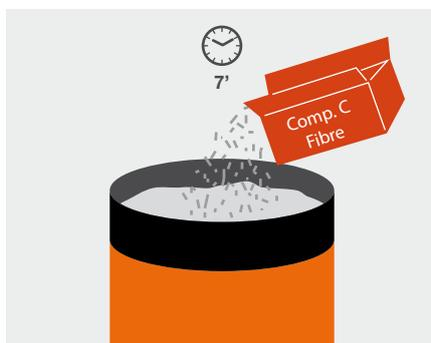
5) Inserire gradualmente il Componente C (fibre), continuando la miscelazione per almeno 2-3 minuti fino ad ottenere una dispersione omogenea delle fibre.
