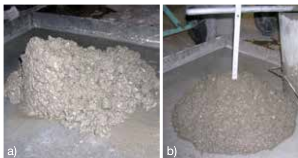
FIGURA 10 Notevole miglioramento della coesione ad opera della Cenere Volante MICRO-POZZ PFA
