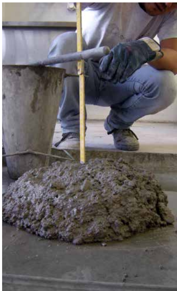
Verifica della consistenza mediante misura dell'abbassamento al cono di Abrams (Norma EN 12350-2)
