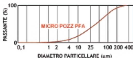
Figura 2 : Distribuzione granulometrica media della cenere volante MICRO POZZ PFA. Il diametro che si legge in corrispondenza del punto di flesso può essere assunto come dimensione media.
