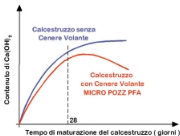
Figura 6: Benefica riduzione del Ca(OH) 2 ad opera della Cenere Volante MICRO POZZ PFA
